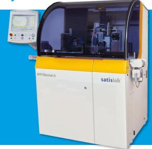
CNC-gestützte automatisierte Lösungen für hochqualitative Oberflächenbearbeitung von optischen Linsen und Gläsern erfordern eine präzise Erkennung von Markierungen. Erst so ist eine genau Ausrichtung in der Verarbeitung von Kunststoffblöcken möglich. Satisloh, ein weltweit führender Maschinenfabrikant, baut auf die kompakten USB 3.0 Kameras von NET in Verbindung mit der passenden Beleuchtung und Optik. Eine gute Wahl für den zuverlässigen 24/7 Einsatz in der Industrie.
